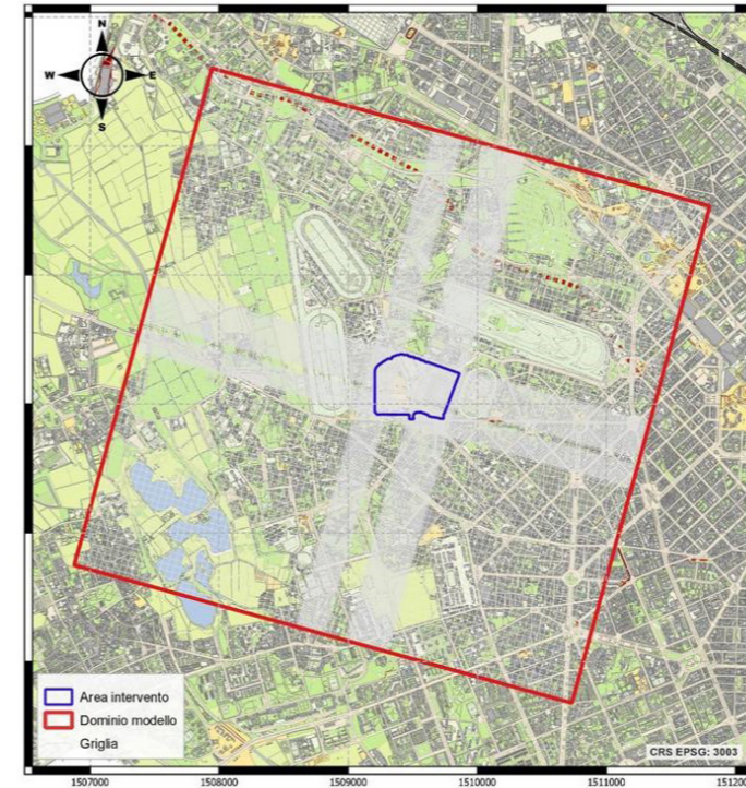
Fig.04: Definizione della griglia alle differenze finite
