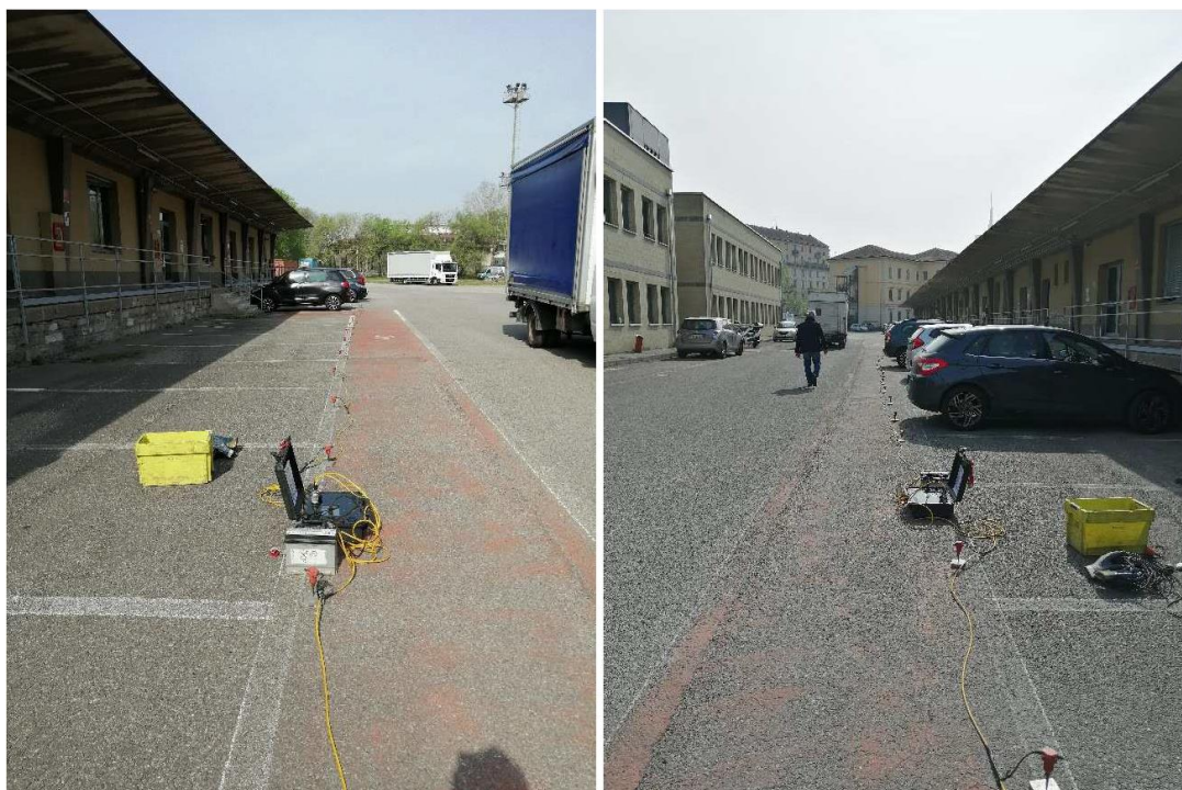
Figura 4.3 – Esecuzione della prova sismica MASW
