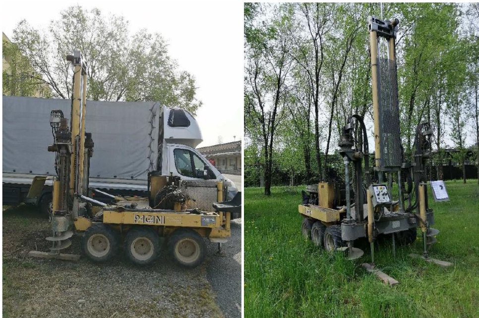
Figura 5.1 – Esecuzione delle prove SCPT1 e SCPT2
