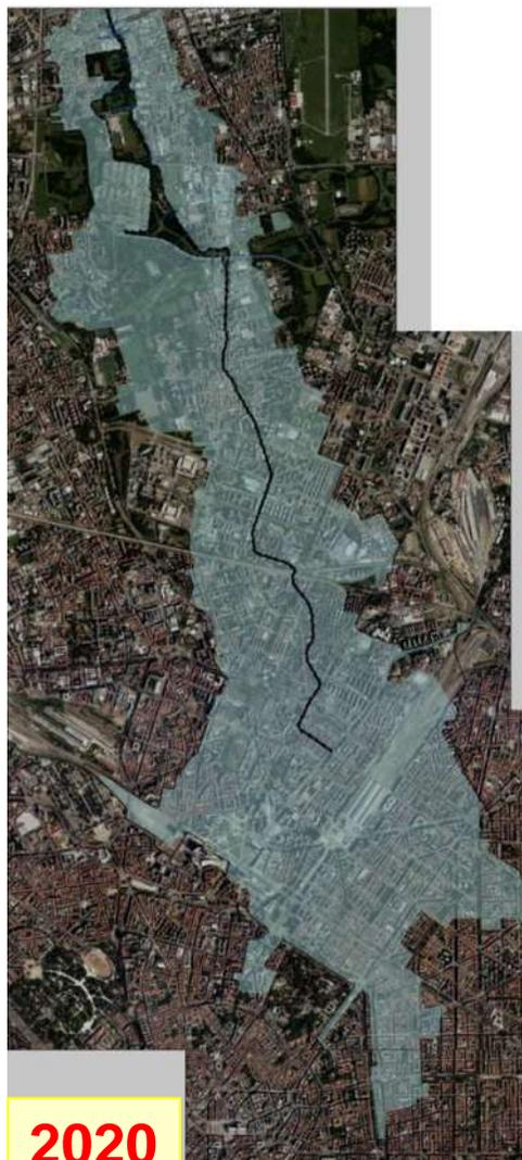
La **"Variante Seveso"** approvata ha utilizzato, per la porzione del corso d'acqua in Milano, i risultati del modello idraulico 2D sviluppato nell'ambito del PGT 2030 messo a punto dal Comune in termini di perimetrazione delle aree inondabili e di delimitazione delle fasce fluviali.
